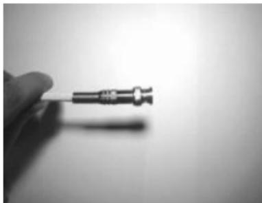
**Важно, чтобы центральная жила не соединялась ни с одним из проводов оплётки – это может привести к короткому замыканию и отсутствию видеосигнала.**
