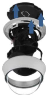
1. Чтобы снять монтажное основание вам необходимо зажать кнопку у основания кабеля питания, что позволит вам снять защитное стекло видеокamеры. После чего с противоположной стороны от основания кабеля оттяните флажок крепления (обозначен желтой стрелкой) на себя и поверните монтажное основание против часовой стрелки.
