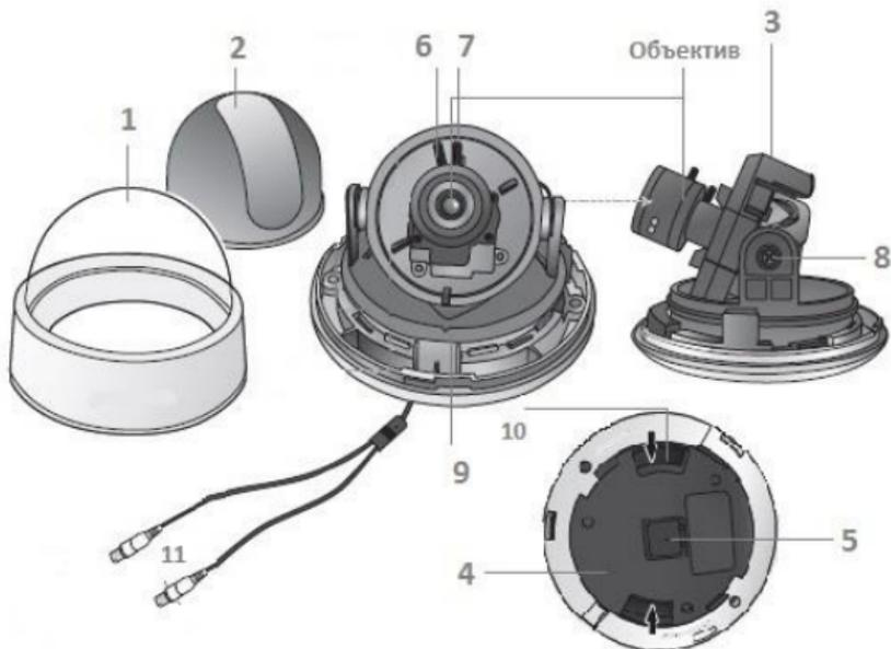
**1. Купольная крышка:** Накрывает внутренний кожух, объектив и корпус видеокамеры.
