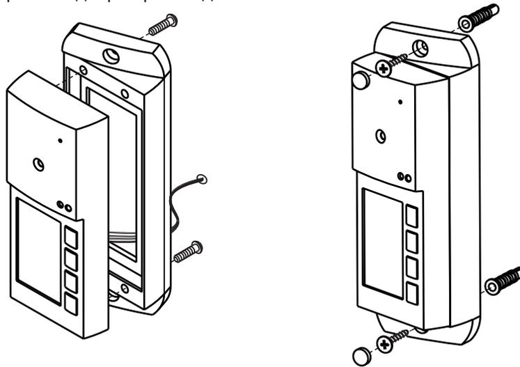
Рисунок 3 - Установка блока справа от двери
